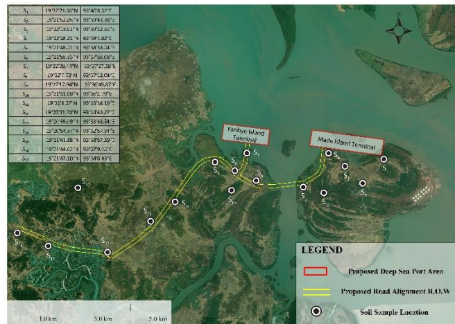
ပုံ-၇။ သက်ရောက်လွှမ်းမိုးမှုရှိနိုင်မည့်ဧရိယာအတွင်းရှိ မြေအရည်အသွေးအချက်အလက်များ ကောက်ယူစုဆောင်းမည့်နေရာပြပုံ
